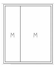
AVK3-6-140-M3 Automatenverteiler, AVK, BxHxT = 800x950x140 Schutzklasse II, IP30, RAL 9016, Aufputz Bestehend aus:
