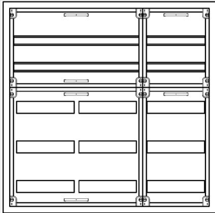
AVK3-5-230-S-PAutomatenverteiler, AVK, BxHxT = 800x800x230 Schutzklasse II, IP54, RAL 7035, Aufputz
