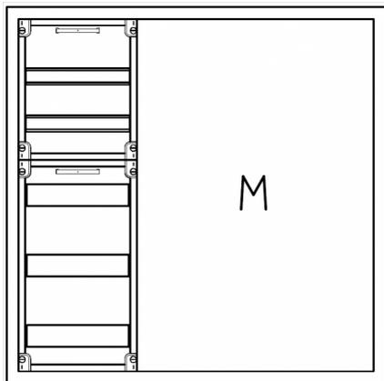
AVK3-5-210-M2 Automatenverteiler, AVK, BxHxT = 800x800x210 Schutzklasse II, IP41, RAL 9016, Aufputz
