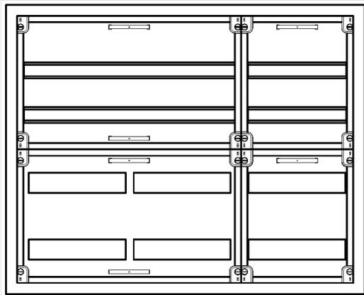
AVK3-4-230-S Automatenverteiler, AVK, BxHxT = 800x650x230 Schutzklasse II, IP54, RAL 7035, Aufputz
