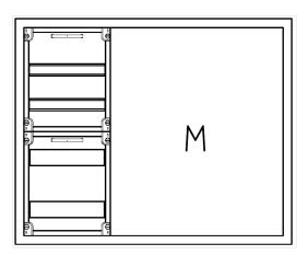
AVK3-4-230-M2Automatenverteiler, AVK, BxHxT = 800x650x230Schutzklasse II, IP54, RAL 7035, AufputzBestehend aus:Gehäuse, Einzeltür mit Schwenkhebel für PHZ, Flansche SF45(oben) und SF41 (unten), 1x Geräteträger 1-Feld breit 2/2 mit Feldabdeckungen PRL, 1x Montageplatte 2-Feld breit
