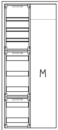
AVK2-8-210-M1 Automatenverteiler, AVK, BxHxT = 550x1250x210 Schutzklasse II, IP41, RAL 9016, Aufputz
