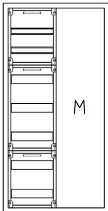
AVK2-7-230-M1-PAutomatenverteiler, AVK, BxHxT = 550x1100x230Schutzklasse II, IP54, RAL 7035, AufputzBestehend aus:Gehäuse, Einzeltür mit Schwenkhebel für PHZ, Flansche SF45(oben) und SF41 (unten), 1x Geräteträger 1-Feld breit 2/5 mit Feldabdeckungen PS, 1x Montageplatte 1-Feld breit
