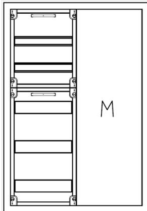
AVK2-5-230-M1-PAutomatenverteiler, AVK, BxHxT = 550x800x230Schutzklasse II, IP54, RAL 7035, AufputzBestehend aus:Gehäuse, Einzeltür mit Schwenkhebel für PHZ, Flansche SF45(oben) und SF41 (unten), 1x Geräteträger 1-Feld breit 2/3 mit Feldabdeckungen PS, 1x Montageplatte 1-Feld breit
