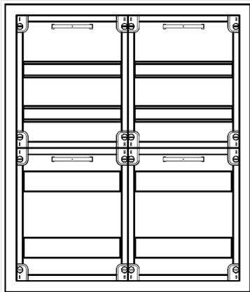
AVK2-4-230-S-PAutomatenverteiler, AVK, BxHxT = 550x650x230 Schutzklasse II, IP54, RAL 7035, Aufputz
