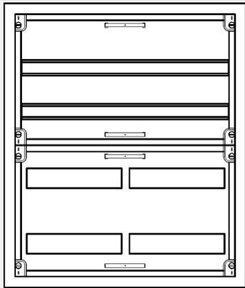
AVK2-4-210-PAutomatenverteiler, AVK, BxHxT = 550x650x210Schutzklasse II, IP41, RAL 9016, AufputzBestehend aus:Gehäuse, Einzeltür mit Drehriegel, Flansche NF1 (oben) und NF2 (unten), 1x Geräteträger 2-Feld breit 2/2 mit Feldabdeckungen PS
