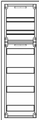
AVK1-6-210-PAutomatenverteiler, AVK, BxHxT = 300x950x210 Schutzklasse II, IP41, RAL 9016, Aufputz
