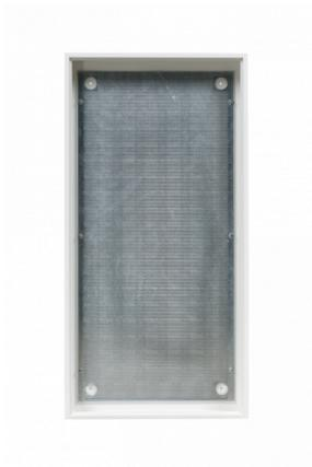
AVBM2-8-230 Automatenverteiler mit Montageplatte gelocht auf Rückwand, AVB, BxHxT = 550x1250x230 Schutzklasse I, IP41, RAL 7035, Aufputz. Bestehend aus: Gehäuse, Einzeltür mit Schwenkhebel für PHZ, Flansche SF45 (oben) und SF41 (unten)
