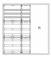
AVB5-9-230-M2Automatenverteiler, AVB, BxHxT = 1300x1400x230Schutzklasse I, IP54, RAL 7035, AufputzBestehend aus:Gehäuse, Doppeltür mit Schwenkhebel für PHZ, Flansche SF45 (oben) und SF41 (unten), 1x Geräteträger 2-Feld breit 3/6 mit Feldabdeckungen PRL, 1x Geräteträger 1-Feld breit 3/6 mit Feldabdeckungen PRL, 1x Montageplatte 2-Feld breit
