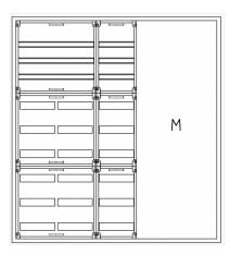
AVB5-9-230-M2-PAutomatenverteiler, AVB, BxHxT = 1300x1400x230Schutzklasse I, IP54, RAL 7035, AufputzBestehend aus:Gehäuse, Doppeltür mit Schwenkhebel für PHZ, Flansche SF45 (oben) und SF41 (unten), 1x Geräteträger 2-Feld breit 3/6 mit Feldabdeckungen PS, 1x Geräteträger 1-Feld breit 3/6 mit Feldabdeckungen PS, 1x Montageplatte 2-Feld breit
