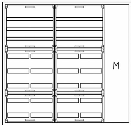
AVB5-8-210-M1 Automatenverteiler, AVB, BxHxT = 1300x1250x210 Schutzklasse I, IP41, RAL 9016, Aufputz
