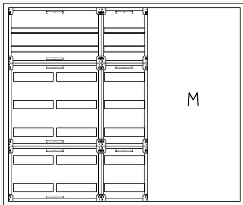
AVB5-7-230-M2 Automatenverteiler, AVB, BxHxT = 1300x1100x230 Schutzklasse I, IP54, RAL 7035, Aufputz
