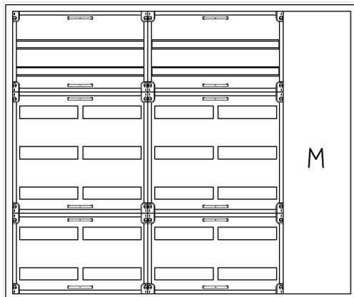
AVB5-7-230-M1-PAutomatenverteiler, AVB, BxHxT = 1300x1100x230Schutzklasse I, IP54, RAL 7035, AufputzBestehend aus:Gehäuse, Doppeltür mit Schwenkhebel für PHZ, Flansche SF45 (oben) und SF41 (unten), 2x Geräteträger 2-Feld breit 2/5 mit Feldabdeckungen PS, 1x Montageplatte 1-Feld breit
