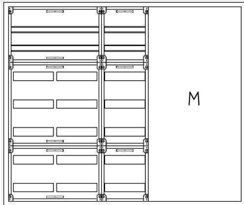
AVB5-7-210-M2-PAutomatenverteiler, AVB, BxHxT = 1300x1100x210Schutzklasse I, IP41, RAL 9016, AufputzBestehend aus:Gehäuse, Doppeltür mit Drehriegel, Flansche NF1 (oben) und NF2 (unten), 1x Geräteträger 2-Feld breit 2/5 mit Feldabdeckungen PS, 1x Geräteträger 1-Feld breit 2/5 mit Feldabdeckungen PS, 1x Montageplatte 2-Feld breit
