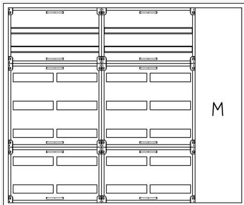
AVB5-7-210-M1-PAutomatenverteiler, AVB, BxHxT = 1300x1100x210Schutzklasse I, IP41, RAL 9016, AufputzBestehend aus:Gehäuse, Doppeltür mit Drehriegel, Flansche NF1 (oben) und NF2 (unten), 2x Geräteträger 2-Feld breit 2/5 mit Feldabdeckungen PS, 1x Montageplatte 1-Feld breit
