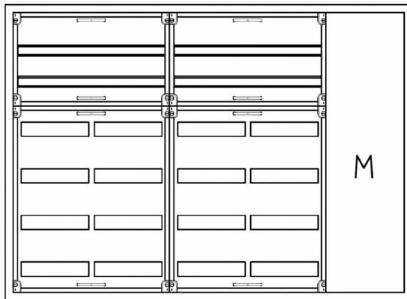
AVB5-6-230-M1 Automatenverteiler, AVB, BxHxT = 1300x950x230 Schutzklasse I, IP54, RAL 7035, Aufputz
