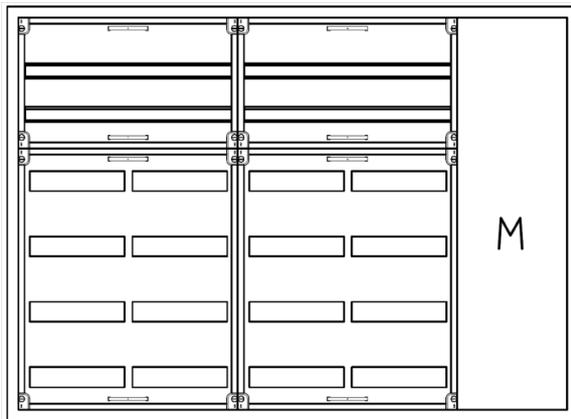
AVB5-6-230-M1-PAutomatenverteiler, AVB, BxHxT = 1300x950x230Schutzklasse I, IP54, RAL 7035, AufputzBestehend aus:Gehäuse, Doppeltür mit Schwenkhebel für PHZ, Flansche SF45 (oben) und SF41 (unten), 2x Geräteträger 2-Feld breit 2/4 mit Feldabdeckungen PS, 1x Montageplatte 1-Feld breit
