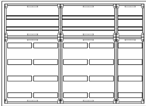
AVB5-6-210-S-PAutomatenverteiler, AVB, BxHxT = 1300x950x210Schutzklasse I, IP41, RAL 9016, AufputzBestehend aus:Gehäuse, Doppeltür mit Drehriegel, Flansche NF1 (oben) und NF2 (unten), 2x Geräteträger 2-Feld breit 2/4 mit Feldabdeckungen PS, 1x Geräteträger 1-Feld breit 2/4 mit Feldabdeckungen PS
