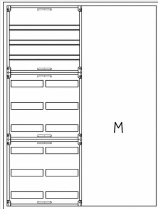
AVB4-9-230-M2-PAutomatenverteiler, AVB, BxHxT = 1050x1400x230Schutzklasse I, IP54, RAL 7035, AufputzBestehend aus:Gehäuse, Doppeltür mit Schwenkhebel für PHZ, Flansche SF45 (oben) und SF41 (unten), 1x Geräteträger 2-Feld breit 3/6 mit Feldabdeckungen PS, 1x Montageplatte 2-Feld breit
