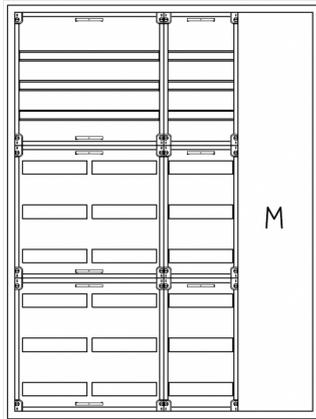
AVB4-9-230-M1-PAutomatenverteiler, AVB, BxHxT = 1050x1400x230Schutzklasse I, IP54, RAL 7035, AufputzBestehend aus:Gehäuse, Doppeltür mit Schwenkhebel für PHZ, Flansche SF45 (oben) und SF41 (unten), 1x Geräteträger 2-Feld breit 3/6 mit Feldabdeckungen PS, 1x Geräteträger 1-Feld breit 3/6 mit Feldabdeckungen PS, 1x Montageplatte 1-Feld breit
