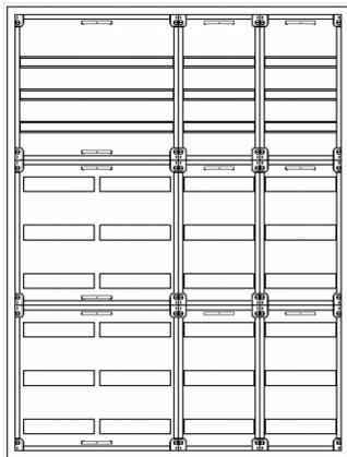
AVB4-9-210-S Automatenverteiler, AVB, BxHxT = 1050x1400x210 Schutzklasse I, IP41, RAL 9016, Aufputz
