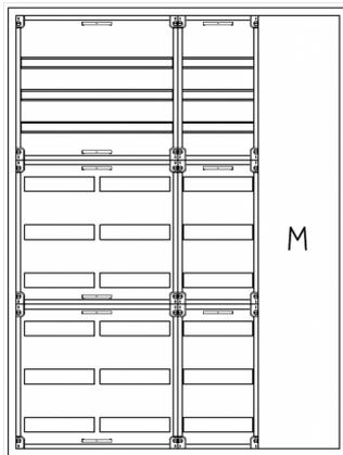
AVB4-9-210-M1-PAutomatenverteiler, AVB, BxHxT = 1050x1400x210Schutzklasse I, IP41, RAL 9016, AufputzBestehend aus:Gehäuse, Doppeltür mit Drehriegel, Flansche NF1 (oben) und NF2 (unten), 1x Geräteträger 2-Feld breit 3/6 mit Feldabdeckungen PS, 1x Geräteträger 1-Feld breit 3/6 mit Feldabdeckungen PS, 1x Montageplatte 1-Feld breit
