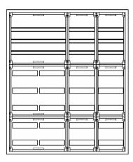
AVB4-8-210-SAutomatenverteiler, AVB, BxHxT = 1050x1250x210Schutzklasse I, IP41, RAL 9016, AufputzBestehend aus:Gehäuse, Doppeltür mit Drehriegel, Flansche NF1 (oben) und NF2 (unten), 1x Geräteträger 2-Feld breit 3/5 mit Feldabdeckungen PRL, 2x Geräteträger 1-Feld breit 3/5 mit Feldabdeckungen PRL
