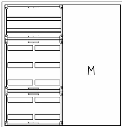
AVB4-7-230-M2-PAutomatenverteiler, AVB, BxHxT = 1050x1100x230Schutzklasse I, IP54, RAL 7035, AufputzBestehend aus:Gehäuse, Doppeltür mit Schwenkhebel für PHZ, Flansche SF45 (oben) und SF41 (unten), 1x Geräteträger 2-Feld breit 2/5 mit Feldabdeckungen PS, 1x Montageplatte 2-Feld breit
