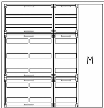
AVB4-7-230-M1-PAutomatenverteiler, AVB, BxHxT = 1050x1100x230Schutzklasse I, IP54, RAL 7035, AufputzBestehend aus:Gehäuse, Doppeltür mit Schwenkhebel für PHZ, Flansche SF45 (oben) und SF41 (unten), 1x Geräteträger 2-Feld breit 2/5 mit Feldabdeckungen PS, 1x Geräteträger 1-Feld breit 2/5 mit Feldabdeckungen PS, 1x Montageplatte 1-Feld breit
