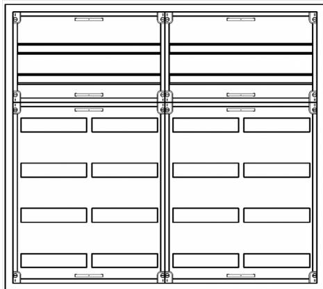
AVB4-6-230 Automatenverteiler, AVB, BxHxT = 1050x950x230 Schutzklasse I, IP54, RAL 7035, Aufputz
