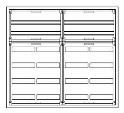
AVB4-6-230-PAutomatenverteiler, AVB, BxHxT = 1050x950x230Schutzklasse I, IP54, RAL 7035, AufputzBestehend aus:Gehäuse, Doppeltür mit Schwenkhebel für PHZ, Flansche SF45 (oben) und SF41 (unten), 2x Geräteträger 2-Feld breit 2/4 mit Feldabdeckungen PS
