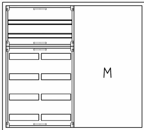
AVB4-6-230-M2 Automatenverteiler, AVB, BxHxT = 1050x950x230 Schutzklasse I, IP54, RAL 7035, Aufputz
