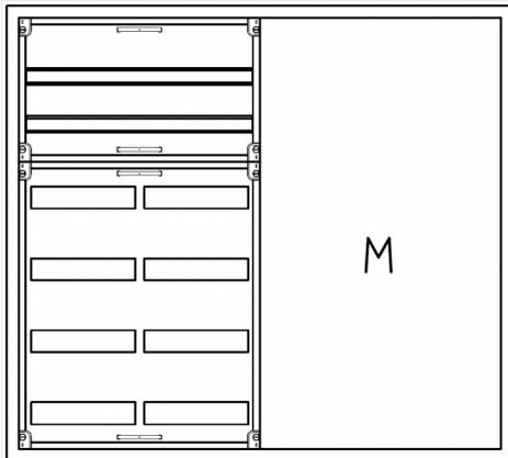
AVB4-6-210-M2-PAutomatenverteiler, AVB, BxHxT = 1050x950x210Schutzklasse I, IP41, RAL 9016, AufputzBestehend aus:Gehäuse, Doppeltür mit Drehriegel, Flansche NF1 (oben) und NF2 (unten), 1x Geräteträger 2-Feld breit 2/4 mit Feldabdeckungen PS, 1x Montageplatte 2-Feld breit
