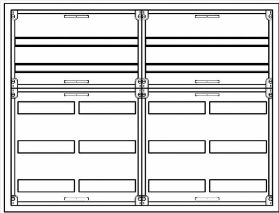
AVB4-5-230 Automatenverteiler, AVB, BxHxT = 1050x800x230 Schutzklasse I, IP54, RAL 7035, Aufputz
