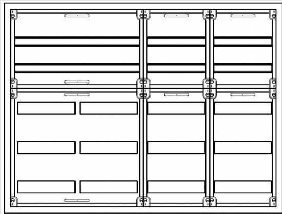
AVB4-5-230-S-PAutomatenverteiler, AVB, BxHxT = 1050x800x230Schutzklasse I, IP54, RAL 7035, AufputzBestehend aus:Gehäuse, Doppeltür mit Schwenkhebel für PHZ, Flansche SF45 (oben) und SF41 (unten), 1x Geräteträger 2-Feld breit 2/3 mit Feldabdeckungen PS, 2x Geräteträger 1-Feld breit 2/3 mit Feldabdeckungen PS
