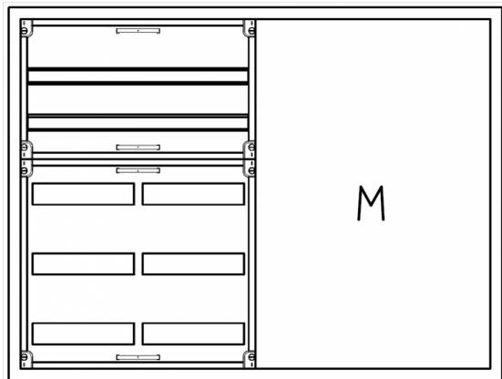
AVB4-5-230-M2-PAutomatenverteiler, AVB, BxHxT = 1050x800x230 Schutzklasse I, IP54, RAL 7035, Aufputz
