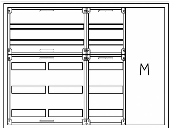
AVB4-5-210-M1 Automatenverteiler, AVB, BxHxT = 1050x800x210 Schutzklasse I, IP41, RAL 9016, Aufputz
