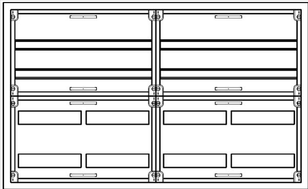
AVB4-4-230-PAutomatenverteiler, AVB, BxHxT = 1050x650x230Schutzklasse I, IP54, RAL 7035, AufputzBestehend aus:Gehäuse, Doppeltür mit Schwenkhebel für PHZ, Flansche SF45 (oben) und SF41 (unten), 2x Geräteträger 2-Feld breit 2/2 mit Feldabdeckungen PS
