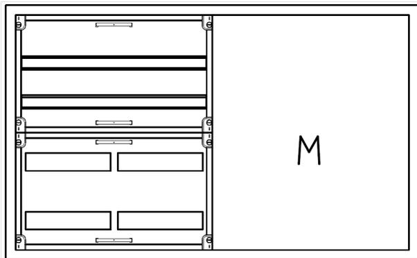
AVB4-4-230-M2-PAutomatenverteiler, AVB, BxHxT = 1050x650x230 Schutzklasse I, IP54, RAL 7035, Aufputz
