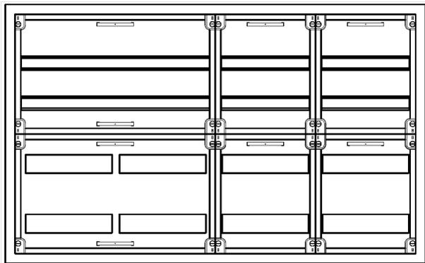
AVB4-4-210-S Automatenverteiler, AVB, BxHxT = 1050x650x210 Schutzklasse I, IP41, RAL 9016, Aufputz Bestehend aus: Gehäuse, Doppeltür mit Drehriegel, Flansche NF1 (oben) und NF2 (unten), 1x Geräteträger 2-Feld breit 2/2 mit Feldabdeckungen PRL, 2x Geräteträger 1-Feld breit 2/2 mit Feldabdeckungen PRL
