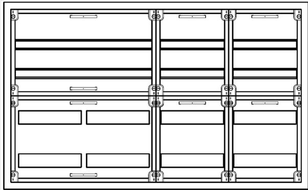
AVB4-4-210-S-PAutomatenverteiler, AVB, BxHxT = 1050x650x210 Schutzklasse I, IP41, RAL 9016, Aufputz Bestehend aus: Gehäuse, Doppeltür mit Drehriegel, Flansche NF1 (oben) und NF2 (unten), 1x Geräteträger 2-Feld breit 2/2 mit Feldabdeckungen PS, 2x Geräteträger 1-Feld breit 2/2 mit Feldabdeckungen PS
