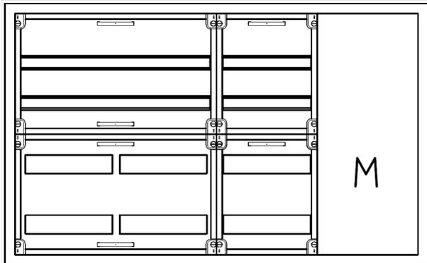
AVB4-4-210-M1 Automatenverteiler, AVB, BxHxT = 1050x650x210 Schutzklasse I, IP41, RAL 9016, Aufputz Bestehend aus: Gehäuse, Doppeltür mit Drehriegel, Flansche NF1 (oben) und NF2 (unten), 1x Geräteträger 2-Feld breit 2/2 mit Feldabdeckungen PRL, 1x Geräteträger 1-Feld breit 2/2 mit Feldabdeckungen PRL, 1x Montageplatte 1-Feld breit
