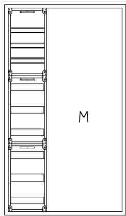
AVB3-9-230-M2-PAutomatenverteiler, AVB, BxHxT = 800x1400x230 Schutzklasse I, IP54, RAL 7035, Aufputz
