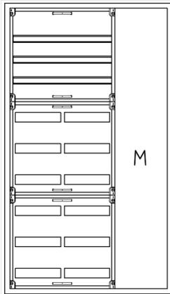
AVB3-9-230-M1-PAutomatenverteiler, AVB, BxHxT = 800x1400x230 Schutzklasse I, IP54, RAL 7035, Aufputz
