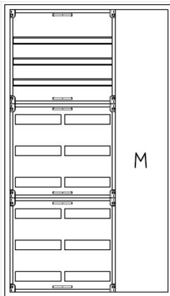
AVB3-9-210-M1-PAutomatenverteiler, AVB, BxHxT = 800x1400x210Schutzklasse I, IP41, RAL 9016, AufputzBestehend aus:Gehäuse, Doppeltür mit Drehriegel, Flansche NF1 (oben) und NF2 (unten), 1x Geräteträger 2-Feld breit 3/6 mit Feldabdeckungen PS, 1x Montageplatte 1-Feld breit
