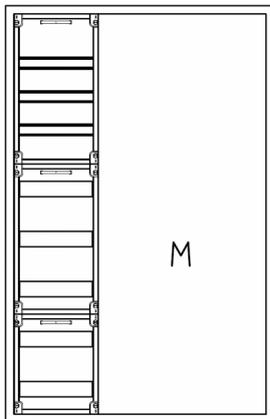
AVB3-8-230-M2 Automatenverteiler, AVB, BxHxT = 800x1250x230 Schutzklasse I, IP54, RAL 7035, Aufputz
