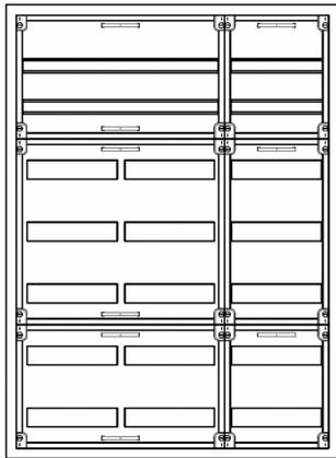
AVB3-7-210-S-PAutomatenverteiler, AVB, BxHxT = 800x1100x210 Schutzklasse I, IP41, RAL 9016, Aufputz
