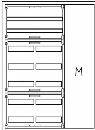
AVB3-7-210-M1-PAutomatenverteiler, AVB, BxHxT = 800x1100x210 Schutzklasse I, IP41, RAL 9016, Aufputz
