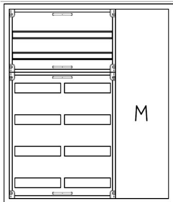
AVB3-6-230-M1-PAutomatenverteiler, AVB, BxHxT = 800x950x230Schutzklasse I, IP54, RAL 7035, AufputzBestehend aus:Gehäuse, Einzeltür mit Schwenkhebel für PHZ, Flansche SF45 (oben) und SF41 (unten), 1x Geräteträger 2-Feld breit 2/4 mit Feldabdeckungen PS, 1x Montageplatte 1-Feld breit
