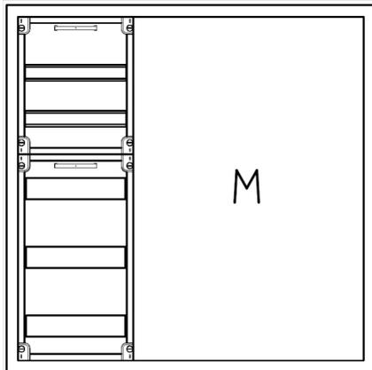
AVB3-5-230-M2-PAutomatenverteiler, AVB, BxHxT = 800x800x230Schutzklasse I, IP54, RAL 7035, AufputzBestehend aus:Gehäuse, Einzeltür mit Schwenkhebel für PHZ, Flansche SF45 (oben) und SF41 (unten), 1x Geräteträger 1-Feld breit 2/3 mit Feldabdeckungen PS, 1x Montageplatte 2-Feld breit
